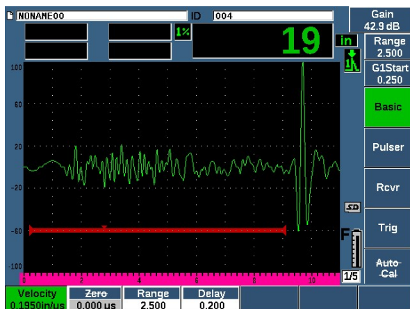
Abbildung 3: Gussteil ohne Fehler.
